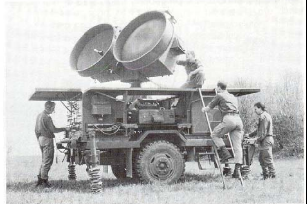
Soldaten der 1. Staffel bei Aufbau und Überprüfung des Beleuchtungsradargerätes „HPIR“
